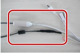
3. Обмотайте остальные кабели изоляционной лентой.
