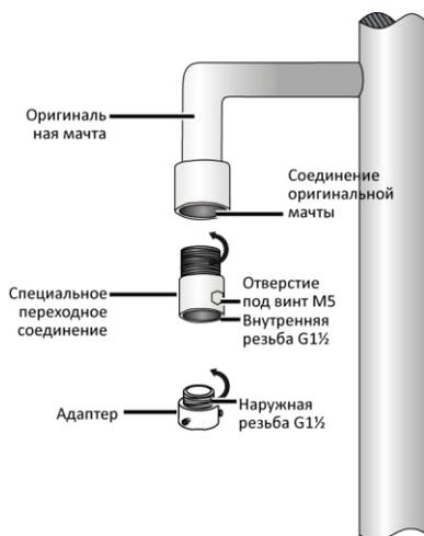
2. Присоедините два адаптера к оригинальной опорной мачте и зафиксируйте их.
