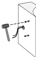
4. Установите кронштейн для крепления на углу и пропустите кабели через отверстие.
