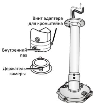
8. Закрепите кронштейн на четырёх расширительных болтах и зафиксируйте его с помощью плоских шайб, пружинных шайб и гаек.
