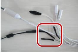
4. Обмотайте все ответвительные кабели изоляционной лентой.
